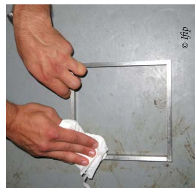
Contrôle du nettoyage-désinfection a avec un essuie-tout
